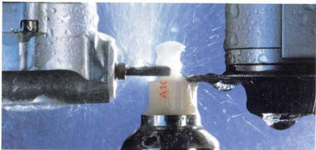
Eine Keramikfüllung wird im CAD/CAM-System (Cerec) gefräst (unten, 4)
